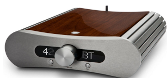
DIA-250S Class-D Vollverstärker/DA-Wandler 2x250W RMS 8Ω Burr-Brown Wandler 24bit/192kHz, aptX Bluetooth
